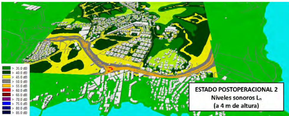
ESTADO POSTOPERACIONAL 2 Niveles sonoros L_e (a 4 m de altura)
